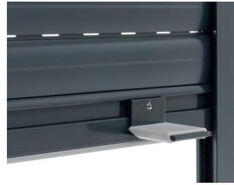
**Seitliche Führungsschienen**, 19 x 27 mm, aus stränggepresstem, anodisiertem oder thermolackiertem Aluminium mit Geräuschkämpfungseinlagen. Bei Breiten über 2'500 mm werden extrabreite Führungsschienen, 19 x 40 mm, geliefert, die dem Panzer mehr Stabilität verleihen.
